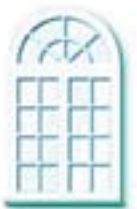
Rundbogenfenster mit Sprossenteilung
